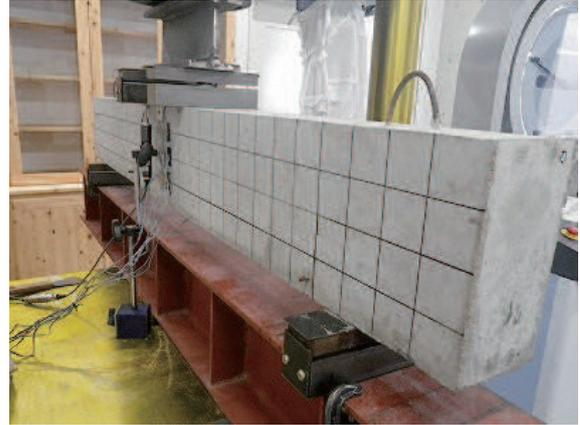
写真-1 竹筋コンクリート梁の曲げ試験
